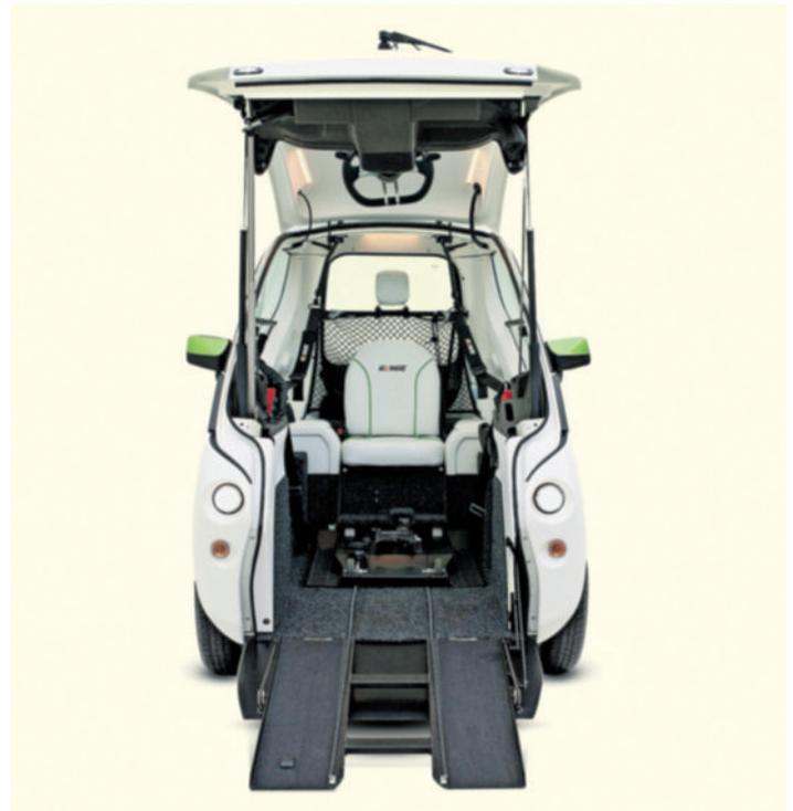
Die stirnseitige Rampe ermöglicht es dem Rollstuhlfahrer, in seinen Wagen einzufahren.
