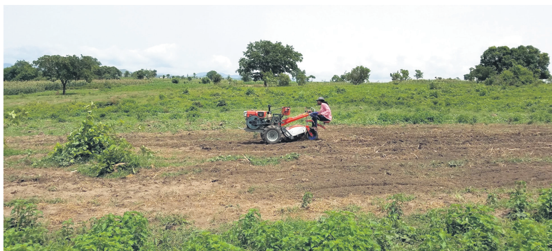
Le tracteur intelligent est doté d'une antenne GPS qui permet de tracer les déplacements et le matériel informatique embarqué. Cela rend possible la collecte et le transfert de données depuis des territoires sans accès à Internet, comme les zones rurales (Ph. Hello Tractor)
